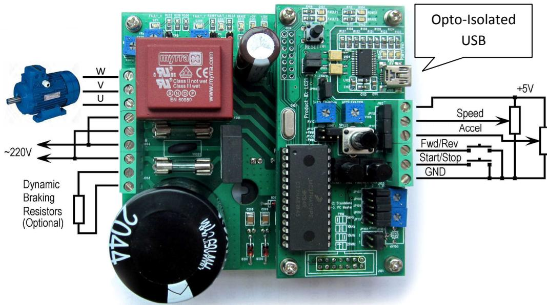
Fig. 2. Wiring
